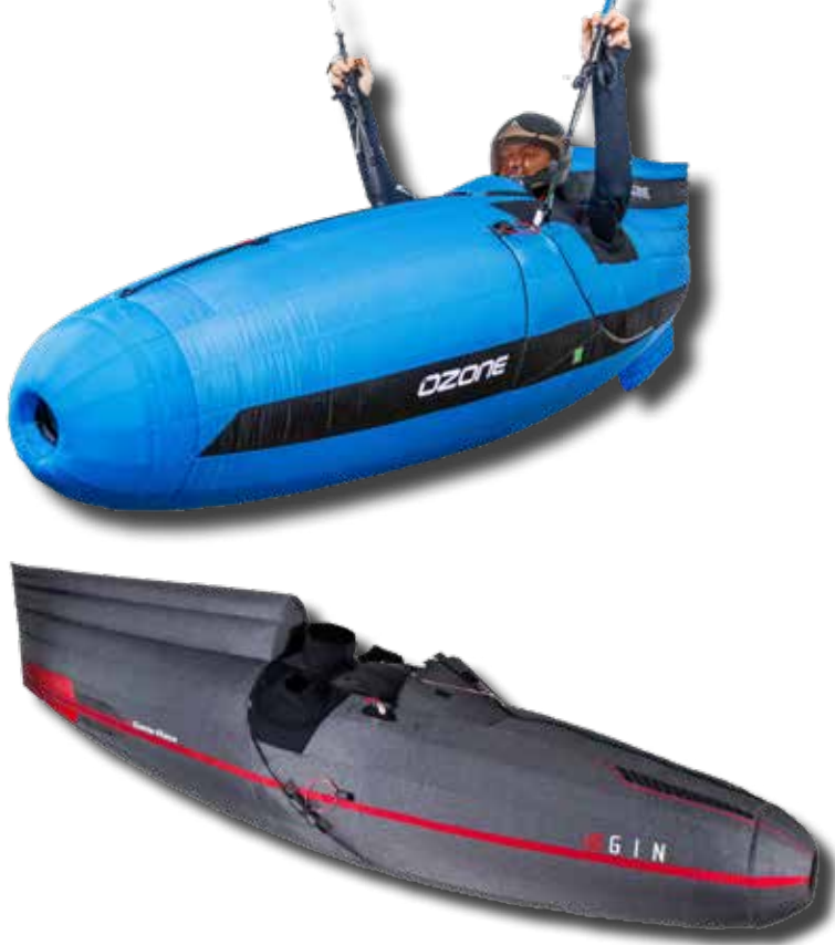
De Ozone Submarine (boven) en de Gin Genie Race 5 waren twee van de eerste gesloten podharnassen bedoeld voor competities op hoog niveau. Veel andere fabrikanten werken nu ook aan zo'n model of hebben deze al op de markt gebracht.
