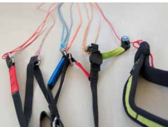
De NyoS 2 RS heeft een zogenaamde C-bridge. Hiermee kan de invalshoek van elke kant gecontroleerd worden, met name tijdens versneld vliegen.
