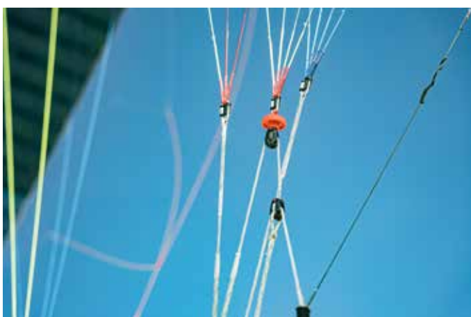
Met de tokkels bedien je zowel de remlijn als de B- en C-lijnen via pully's.
