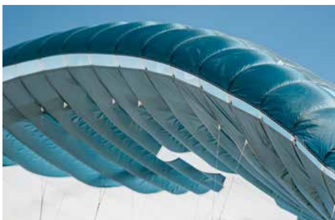
De celopeningen zijn versterkt met halfronde staafjes.
