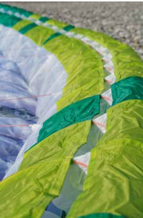
De sharknose wordt ondersteund door plastic staven, die in drie delen bijna over de volledige koorde lopen.
