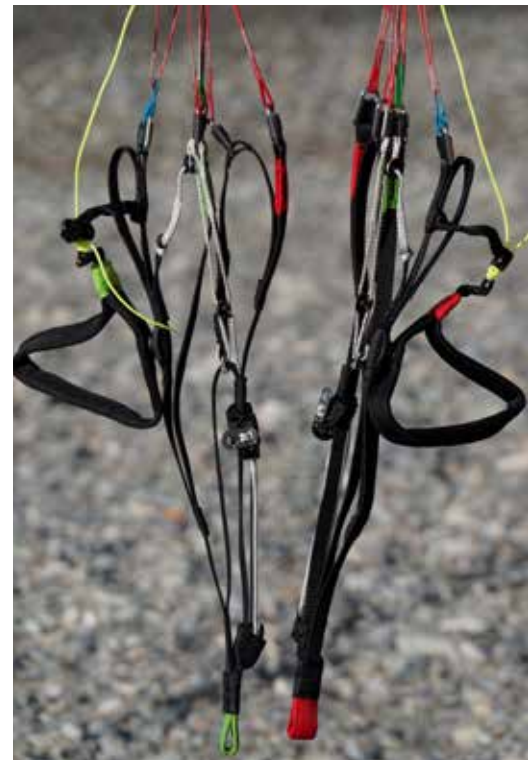
De smalle risers hebben een brede, kleurgecodeerde ophanglus. Het speedsysteem met C-handle is verbonden met de C- en B-risers via lussen die de B-riser voor een derde meetrekken. Dat geeft een lichtere besturing met de C's.
