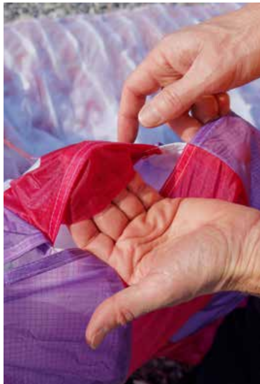
De onderkant van de celopeningen heeft een verdubbelde stuk stof dat van achteren wordt opgeblazen door de interne druk. Dat geeft een gladdere en stabielere leading edge, zegt BGD.
