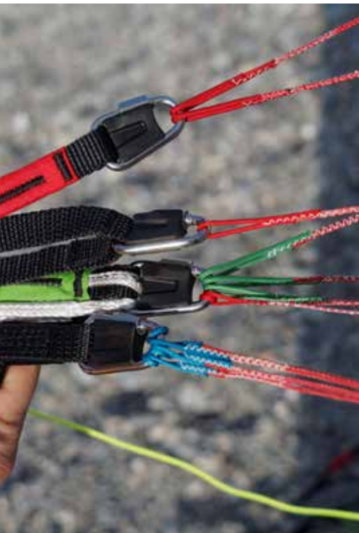
Gesplitste A-risers (rood) met een aparte oren-lijn, plastic clips op de karabiners en trimlus-sen op de C-lijnen en stabilo.
