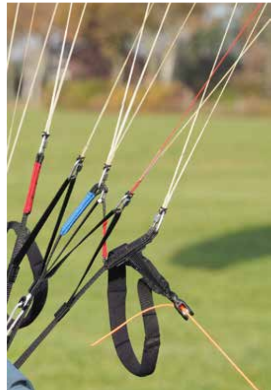
Smalle risers met een grote remlus op een magneet. De binnenste A-lijnen zitten aan de rode riser, de drie B-lijnen zitten aan de blauwe riser. De buitenste A-lijnen voor het trekken van grote oren zitten aan een brug, net als de buitenste C met de rode stabilolijn. De met rood gemarkeerde C-brug verbindt de B-riser met de binnenste C-riser, waardoor de achterste helft van de kap bij het sturen met de C-brug netjes kan kantelen zonder het scherm te vervormen.
