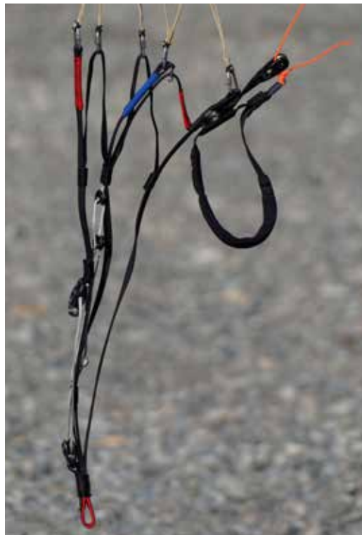
Smalle risers met een grote remlus op een magneet. De binnenste A-lijnen zitten aan de rode riser, de drie B-lijnen zitten aan de blauwe riser. De buitenste A-lijnen voor het trekken van grote oren zitten aan een brug, net als de buitenste C met de rode stabilolijn. De met rood gemarkeerde C-brug verbindt de B-riser met de binnenste C-riser, waardoor de achterste helft van de kap bij het sturen met de C-brug netjes kan kantelen zonder het scherm te vervormen.
