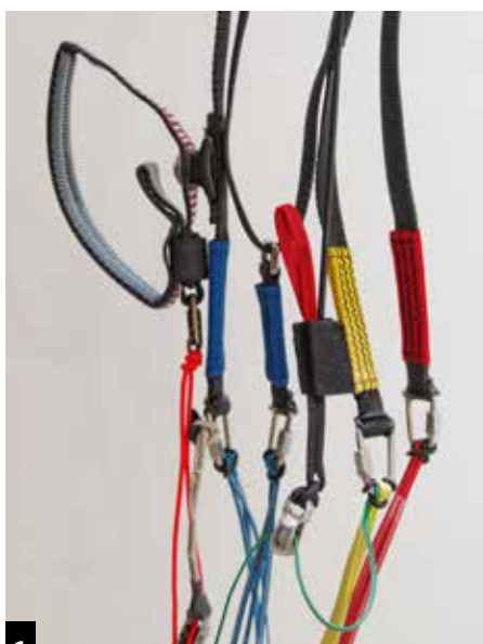
1 De smalle risers zien er overzichtelijk uit, de lijnen zijn gemanteld en hebben een kleurcode. Interessant is de Stabilo Security-functie (op de groene stabilolijn). De serieproductie is standaard voorzien van acrotoggles.
