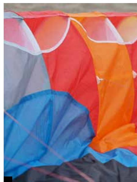
3 De leading edge met karakteristieke ronde celopeningen en korte staafjes van 30 cm om de cellen open te houden. De toplijnen zijn allemaal ongemanteld.
