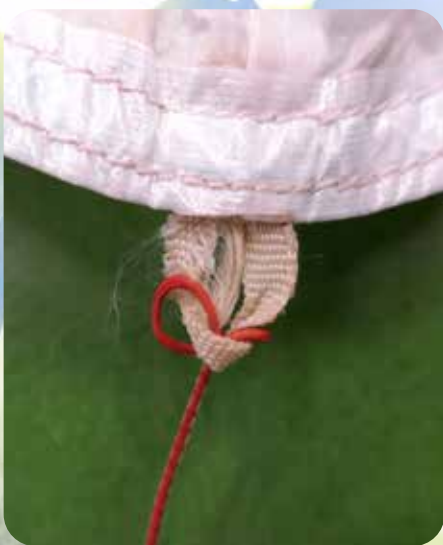
Slijtage aan de aanhechtingspunten van de remlijn.
