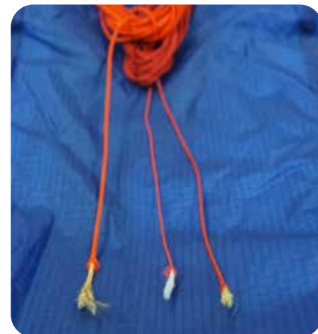
Andere lijnen breken op de zwakste plek. Misschien zat hier een knik of beschadiging
